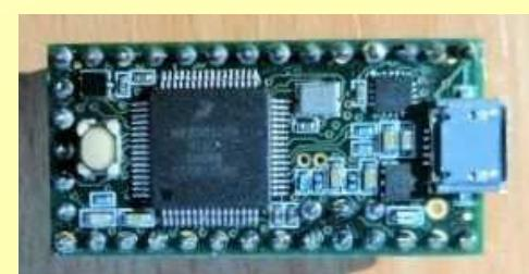
Mikroupravljač: Teensy 3.2, kompatibilan s Arduinom softverom.
